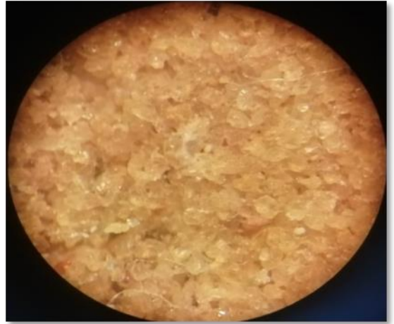
صورة رقم (10) توضح صورة مجهرية للعينة التجريبية بعد تطبيق أنزيم البروتيز المحمل علي بوليمر الفاكر OH النقي مع نانو السليكا \text{SiO}_2 عليها وتنظيف بقع دم الوطاويط من الحجر الرملي
